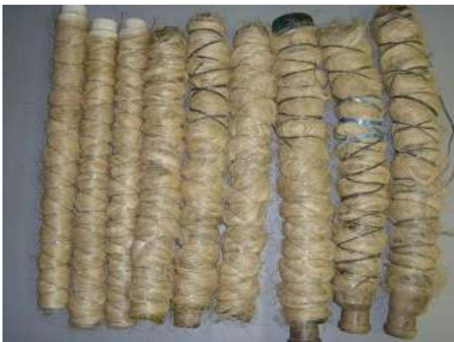
Figura1. Tubos com envoltórios de sisal.
