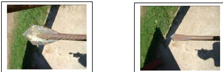
FIGURA 1. Ferramentas utilizadas na usinagem dos dutos de bambu.
